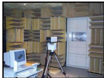
悄声室混响室法隔声量测量
